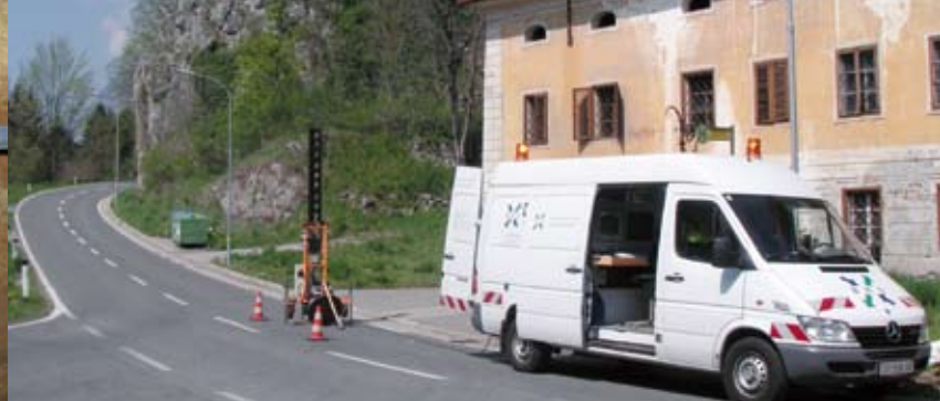
CUS-Sensoreinheit mit Lasermess-System und hochauflösender CCD-Farbkamera mit bis zu 20-fachem Zoom
