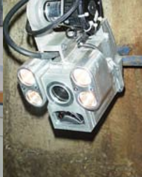
CUS-Sensoreinheit mit Lasermess-System und hochauflösender CCD-Farbkamera mit bis zu 20-fachem Zoom
